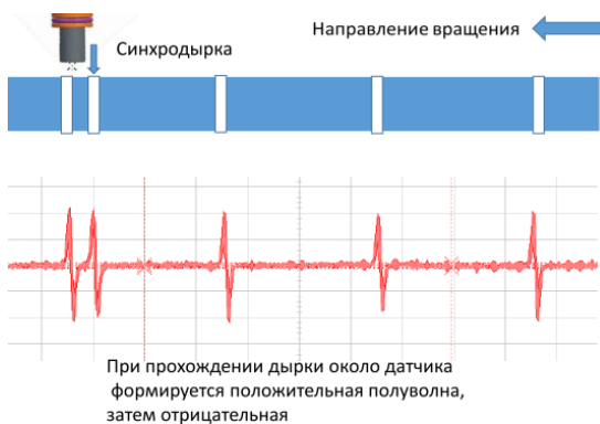
Рисунок 2 - Форма сигнала с датчика частоты вращения распределительного вала
